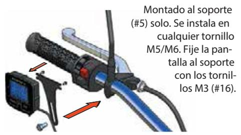
Montado al soporte (#5) solo. Se instala en cualquier tornillo M5/M6. Fije la pantalla al soporte con los tornillos M3 (#16).
