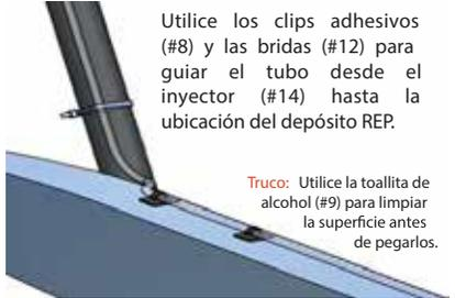
Utilice los clips adhesivos (#8) y las bridas (#12) para guiar el tubo desde el inyector (#14) hasta la ubicación del depósito REP.
