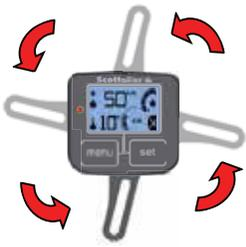
La pantalla se puede instalar en cuatro posiciones sobre el soporte.
