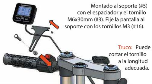
Montado al soporte (#5) con el espaciador y el tornillo M6x30mm (#3). Fije la pantalla al soporte con los tornillos M3 (#16).
