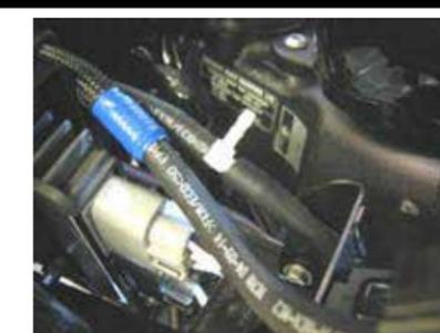
Instale la pieza "T" 6mm y coloque el codo negro 4mm.
