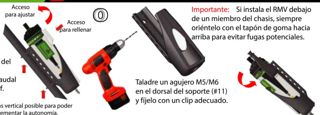
**Importante:** Si instala el RMV debajo de un miembro del chasis, siempre orientelo con el tapón de goma hacia arriba para evitar fugas potenciales.
